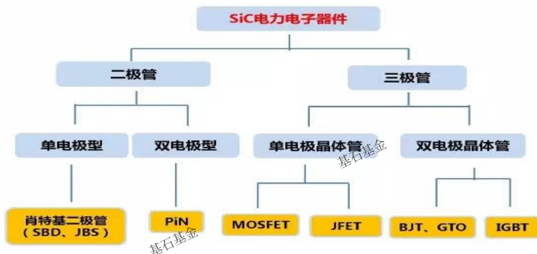
图表 2-15 碳化硅电力电子器件分类
